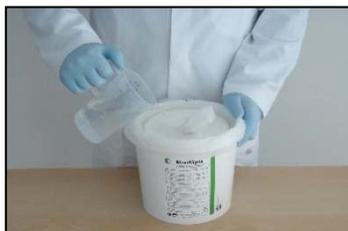
2.\*\* Die trockenen Reels mit **MinutenSpray-classic** (2,5 L bei MaxiWipes reel/ MaxiWipes-L reel) oder **PlastiSept eco-Lösung** (1,4 L bei MaxiWipes reel/ 1,6 L bei MaxiWipes-L reel) tränken.
